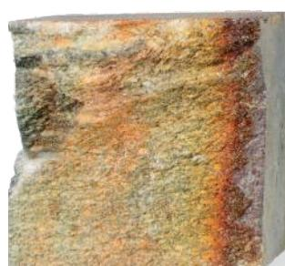
Povrch kamene topeniště znázorněný na obrázku při používání změnil svou barvu na světle hnědou. Uhličitan hořečnatý přítomný v povrchu mastku se při teplotách nad 520 °C mění na periklas ( $MgO$ ). Tento periklas a talek mastku se pak spěkají dohromady a vytvářejí extrémně tvrdý povrch topeniště. Tento povrch vydrží desítky let používání a umožnuje rychlé ukládání tepla. Mastková topeniště Nunnauuni nevyžadují izolační ochranné desky nebo lité konstrukce.
